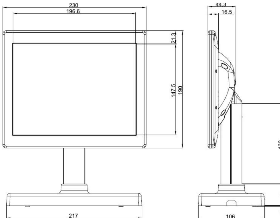
Abbildung 3 – Abmessungen mocca.display 10"
