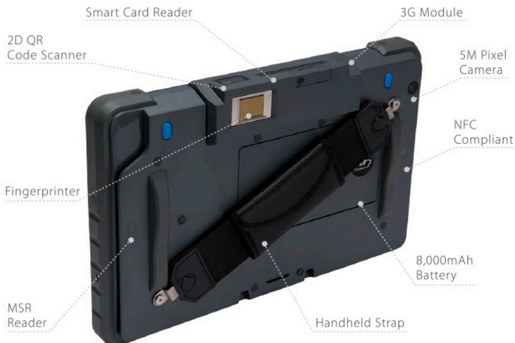
Abbildung 3 – moCCA.info+ Rückansicht mit Erklärung der optional verbauten Komponenten
