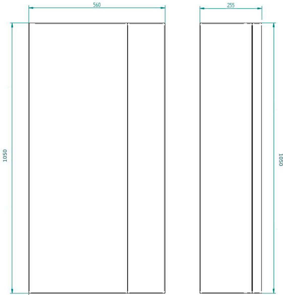
Abbildung 8 – Abmessungen Standfuß moCCA.value+
