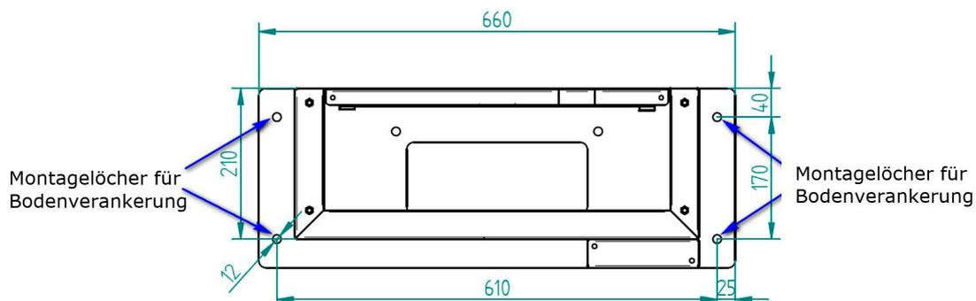
Abbildung 7 – Abmessungen für Montage moCCA.value+ mit Standfuß
