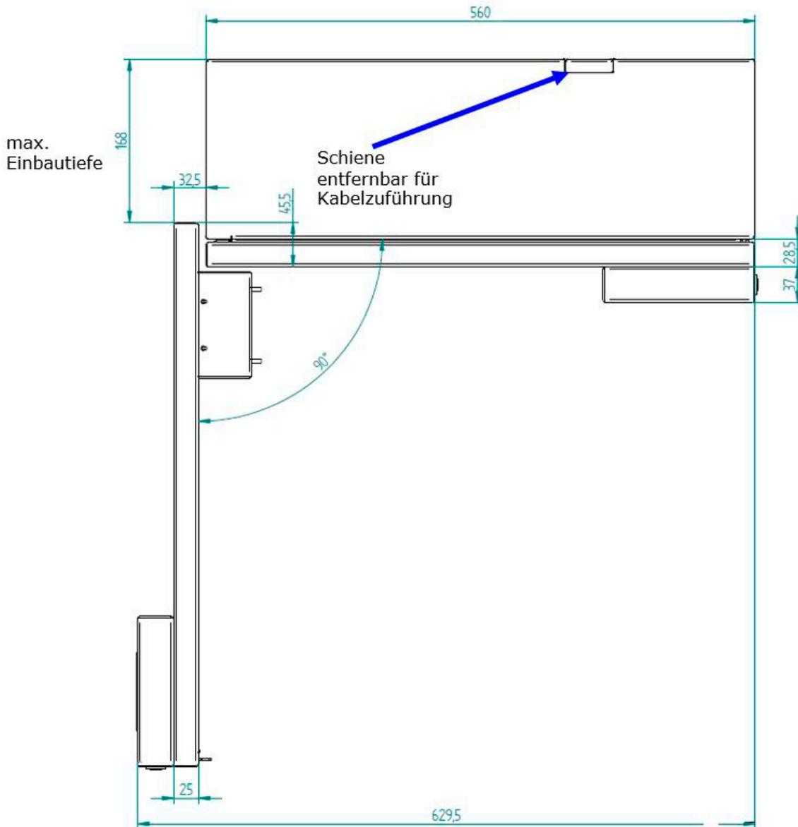
Abbildung 5 – Ansicht von oben moCCA.value+ mit geöffneter Türe
