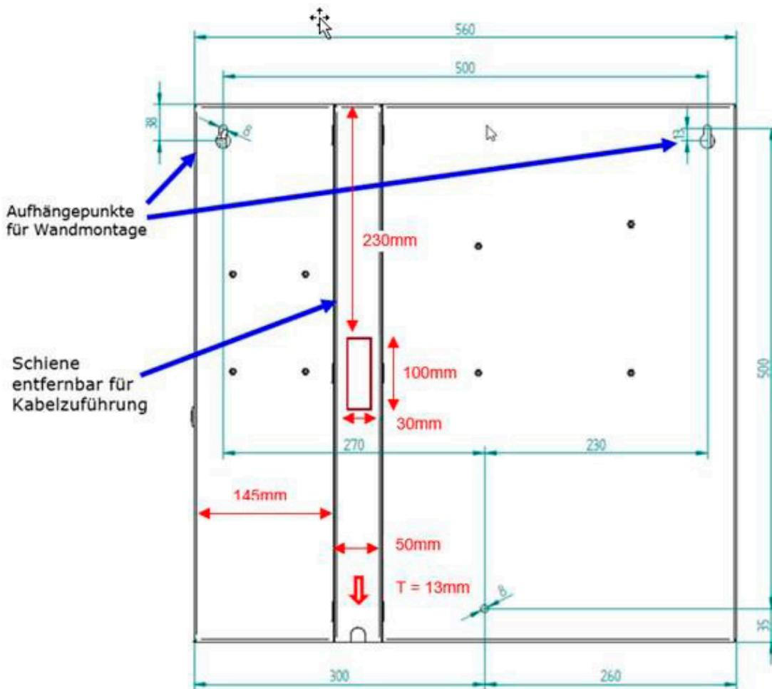
Abbildung 6 – Rückansicht moCCA.value+ mit Maßen für Wandmontage und Öffnung für Kabel
