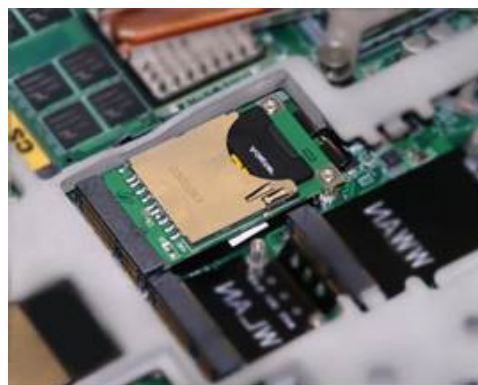
Abbildung zeigt Aufrüstvariante für internen Einbau über PCIe
