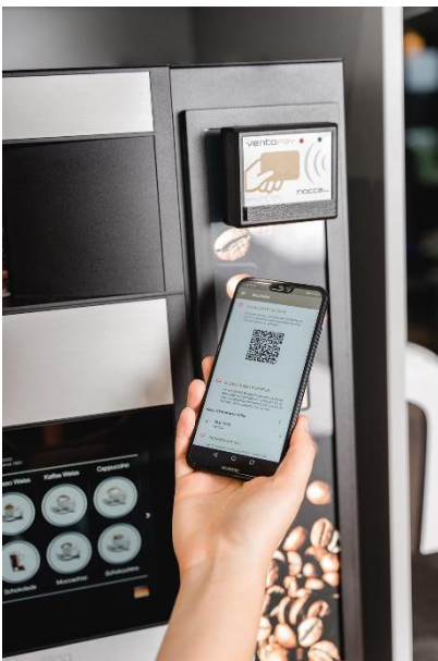
Abbildung 9: Bezahlung per Bluetooth Low Energy am Automaten
